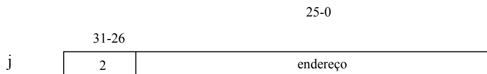
Figura 4.12. Formato de instrução de desvio incondicional
